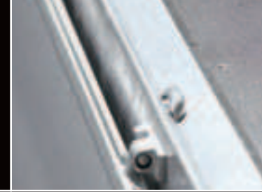
Sicherheits-V-Zurrnut und Verzurrbügel zur Ladungssicherung mit dem Außenrahmen verbunden
