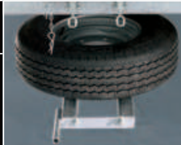
Ersatzradhalter als Korb unter der Ladefläche
