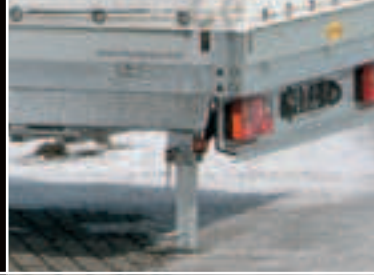
Massiver Stützfuß zur Heckabstützung zum Beladen ohne Zugfahrzeug
