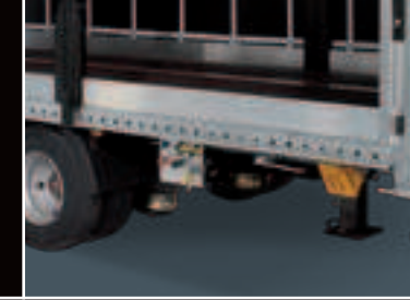
Türfeststeller für Hecktüren, gut zugängliches Bedienfeld für die Druckluftanlage
